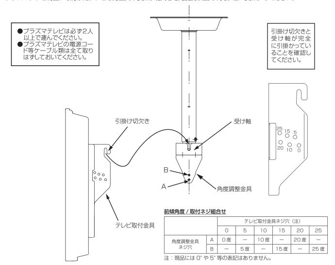
2. プラズマテレビの前傾角度を調節し、角度調節金具の両側から付属の M8×25 ネジ2 本で固定してください。
