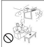
■エアーコンディショ ナーの吹出し、吸込 み口のそばに取付け ないでください。
