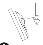
■ プラズマテレビ側のテレビ取付金具と角度調整金具の引掛けつめが確実に入っていることを確認してください。
