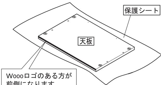
**注意** 製品及び床面の保護のため、設置の際は必ず毛布などの保護シートを敷いた上で作業を行ってください。
