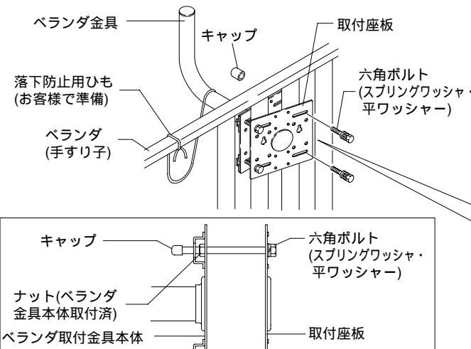
① ベランダ取付金具と取付座板でベランダの格子を挟み込んでください。左図のように取付け後、ボルト4本をしっかりと締め込みます。(適正締付トルクは4.9~5.88N·m(50~60kgf·cm)です。)
