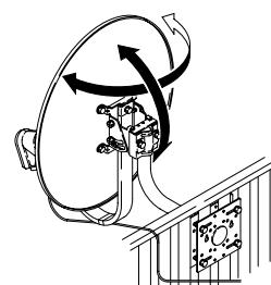
最後に仰角と方位角を微調整し終ったら、ボルト類を十分締付けます。
