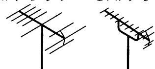
VHFアンテナ UHFアンテナ
