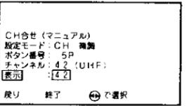
**9** 設定したチャンネルで、微調したい場合は上下で「設定モード」を選び、左右で「微調」に設定する
