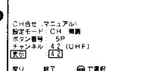
9 設定したチャンネルで、微調したい場合は (△) で「設定モード」を選び、(○) (○) で「微調」に設定する
