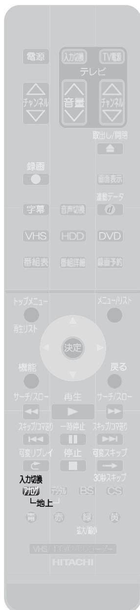
本機の入力1、2(L1、L2)につないだほかの機器からの映像・音声を、本機を経由して視聴したり本機に録画したりするときは、本機を外部入力に切り換えます。外部機器の操作のしかたは、それぞれの機器の取扱説明書をお読みください。
