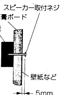
2. 先に本機にスピーカーコードを接続し、裏面中央上部のスピーカー取付穴を利用して、手順1で取り付けたネジに掛けます。
