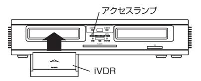
●セキュア対応 iVDR-S を 挿入口に挿入したとき
