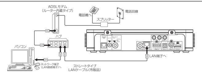
ADSL の場合(3): ADSL モデム (ルーター内蔵タイプ) との接続 (LAN 接続端子に空きがある場合)
