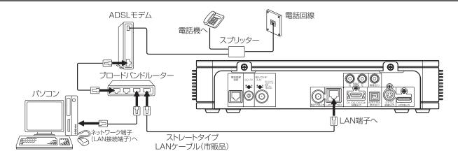
ADSL の場合(2): ADSL モデム (ルーター内蔵タイプ) との接続 (LAN 接続端子に空きがない場合)
