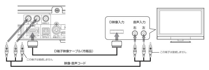
●音声コードは、必ず音声出力端子に接続してください。
