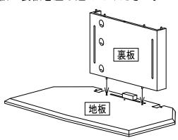
2、地板に図のように支柱を取り付け、地板底面の 下穴に合わせて支柱固定ねじ(10本)で固定して ください。その後、組み立てネジ(3本)で裏板 を固定してください。
