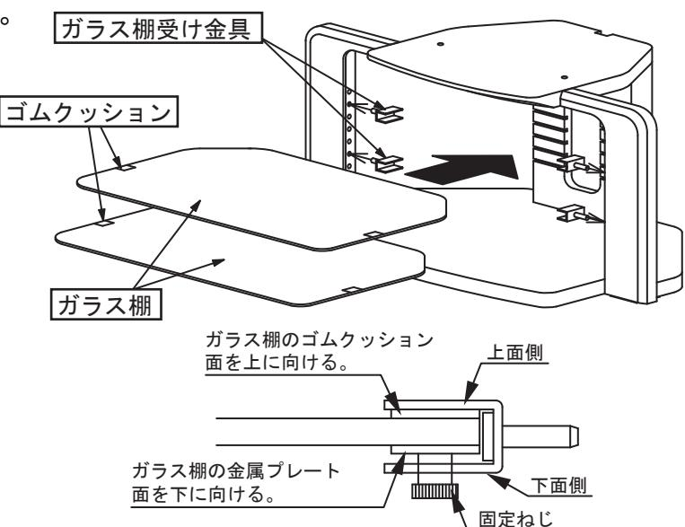
2) ガラス棚を金具の間に入れてください。ガラス後端部を裏板の溝にはめ込んでください。
