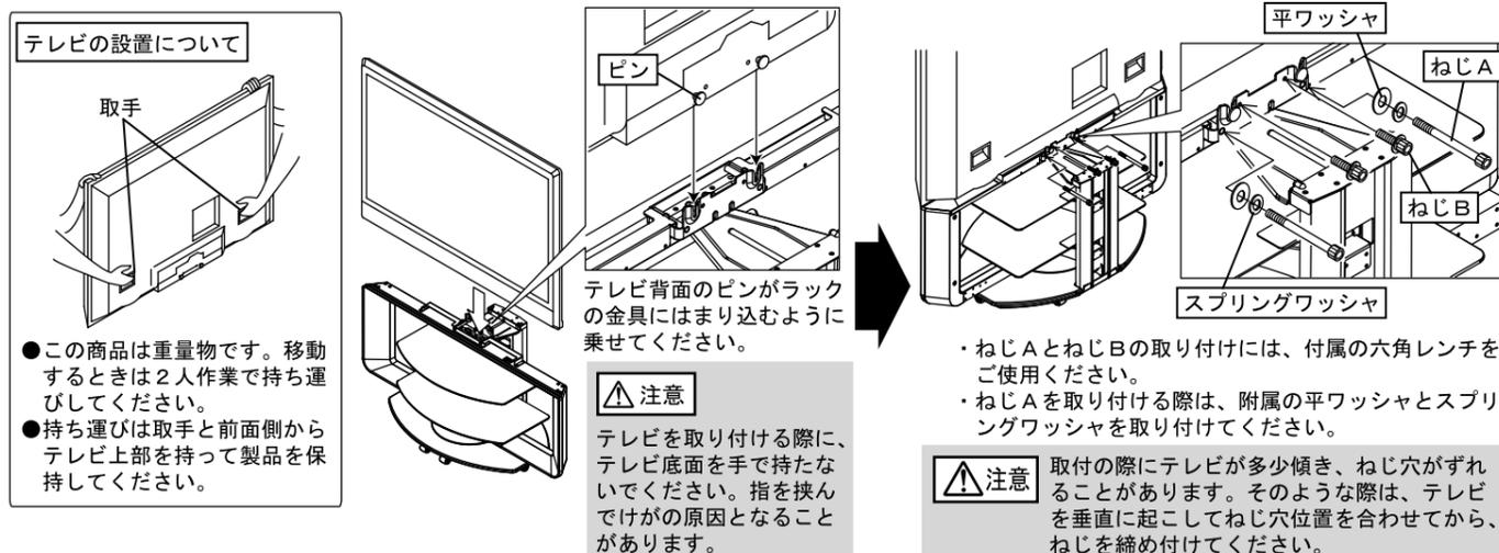
4、テレビ背面のねじ（下2本）をはずして、補強金具を取り付けてください。
