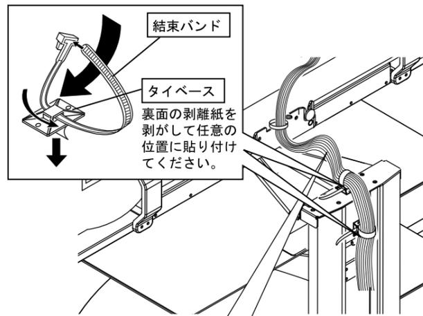
※ケーブル類を固定の際には、回転に支障のないよう、十分なたるみを持たせて固定してください。
