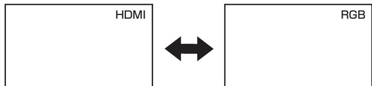
●テレビ動作モードからモニター単体動作モードに切り換わると、「RGB」入力が選択されます。
