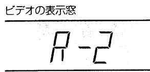
リモコン切換ボタンを押すたびに「R-1」→「R-2」→「R-3」→「R-OFF(切)」の順に切り換わります。
