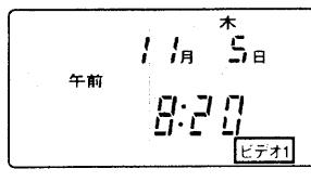
日立製ビデオは工場出荷時、ビデオ側のリモコン切換スイッチを「R-1」に設定してあるため、「ビデオ1」にします。
