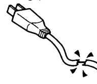
破損したまま使用すると、火災・感電の原因となります。
