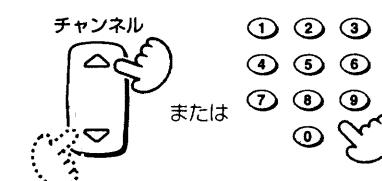
0~9の数字ボタンでひとけたのチャンネルを選ぶときは、最初に0ボタンを押してください(たとえば6チャンネルは0、6と押します)。
