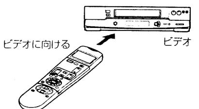
ビデオとリモコンの設定が合っていないと、ビデオの表示窓にビデオのリモコンコードが数秒間点滅します。このときは、ビデオのリモコン切換ボタンをつまようじなどで押して、表示窓に「R-1」を出してください(76ページ参照)。
