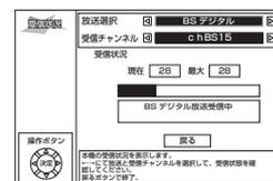
4 アンテナの方向を調整し、受信レベルを最大値にする
