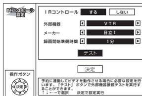
IR コントローラーから信号が 1 回送信され、「外部機器の電源が入ることを確認してください」のメッセージが表示されますので、決定ボタンを押してください。「機器設定」メニューに戻ります。
