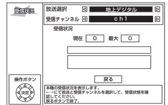
4 アンテナの方向を調整し、受信レベルを最大値にする
