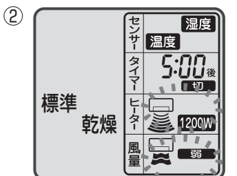
ヒーター・風量の項目表示以外を1秒間隔で点滅
