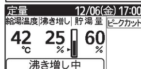
※ ピークカットと沸き上げ時間が重複すると全量貯湯が行えず翌日の湯切れの恐れがありますので、できるだけさけてください。
