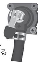
● タンク沸き上げ時は、逃し弁からの膨張水をタンク排水管より排出し、タンク内を一定圧力以下にします。
