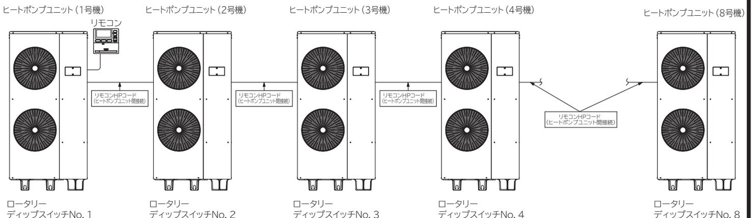
複数台接続する場合は、必ずロータリーディップスイッチでリモコンを接続するヒートポンプユニットをNo.1に、それ以外のヒートポンプユニットはNo.2~8に変更し、号機の設定を行ってください。
