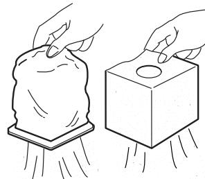
4 スポンジフィルターの穴を上面にして集じん袋を組み立て、元のようにセットする。
