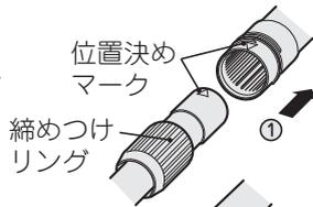
②使いやすい長さに調節し、締めつけリングを回して固定します。
