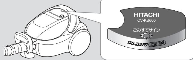
「ごみすてサイン」が点滅したまま運転を続けると、本体モーターの過熱を防ぐために、自動的に電力を抑える保護運転になることがあります。
