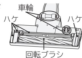
毛足の長いじゅうたんなど床面の種類によっては、操作が重くなることがあります。このようなときは、「弱」運転に切り替えるか、延長管の長さを調節し、グリップハンドルの高さを下げて操作してください。
