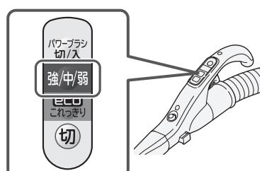
床面の種類やパワー ヘッドの操作のしかたによって、自動運転がうまく作動しないときにもお使いください。回転ブラシの回転を止めたいときは、「パワーブラシ 切/入」ボタンで停止させます。
