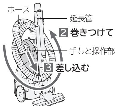
パッとブラシを取り外すと、ホースを延長管に巻きつけて、延長管の差し込み穴にスタンダードフックを差し込めます。
