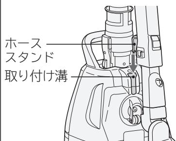
本体を立て、パワーヘッドを床面に置き、延長管を伸ばした状態から徐々に短くして、取り付け溝にホーススタンドを差し込むと楽にセットできます。
