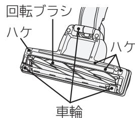
毛足の長いじゅうたんなど床面の種類によっては、操作が重くなることがあります。このようなときは、「弱」運転に切り替えるか、延長管の長さを調節し、グリップハンドルの高さを下げる操作してください。
