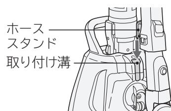
本体を立て、エアー ヘッドを床面にそわせ、取り付け溝にホーススタンドを差し込むと楽にセットできます。
