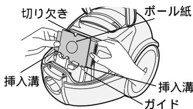
2 ボール紙をガイドの挿入溝に沿って矢印の方向に押し込む
