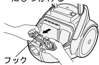
取り付け状態(ボール紙をフックの取り付け線に合わせる)
