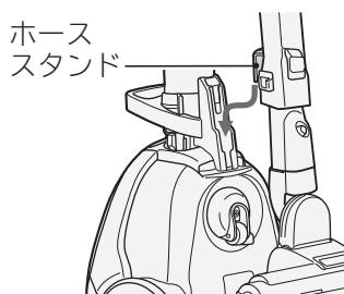
本体を立て、パワーヘッドを床面に置き、延長管を伸ばした状態から徐々に短くして、取り付け溝にホーススタンドを差し込むと楽にセットできます。
