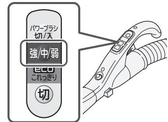
床面の種類やパワー ヘッドの操作のしかたによって、自動運転がうまく作動しないときにもお使いください。回転ブラシの回転を止めたいときは、「パワーブラシ 切/入」ボタンで停止させます。
