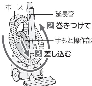
パッとブラシを取り外すと、ホースを延長管に巻きつけて、延長管の差し込み穴にスタンダードフックを差し込めます。
