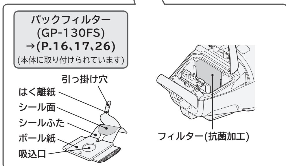
パックフィルターを交換する際は、日立純正(CV-型用)パックフィルターをお買い求めください。→(P.17, 26)
