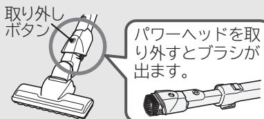
クルッとブラシを延長管(パワーHEADとの間)に取り付けると、ホーススタンドと本体の溝の高さが合わなくなるため、収納ができなくなります。収納するときは延長管から外すか、手もと操作部に取り付けてください。
