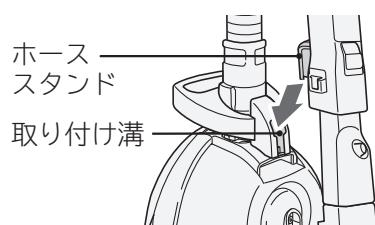
本体を立て、パワー ヘッドを床面にそわせ、取り付け溝にホーススタンドを差し込むと楽にセットできます。
