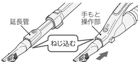
お掃除する場所に合わせてブラシの使い分けができます。切替えブラシの側面を持って矢印の方向に回転させ、先端に固定してください。
