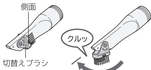
左右いずれかのフックに差し込んで収納します。クルッと切替えブラシ吸口の穴を延長管のフックにしっかりと差し込んでください。
