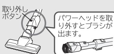
クルッとブラシを延長管(パワーヘッドとの間に取り付けると、ホーススタンドと本体の溝の高さが合わなくなるため、収納ができないになります。収納するときは延長管から外すか、手もと操作部に取り付けてください。
