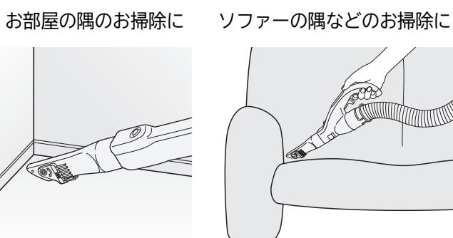
お掃除する場所に合わせてブラシの使い分けができます。切替えブラシの側面を持って矢印の方向に回転させ、先端に固定してください。
