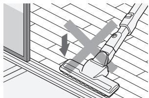
●車輪にごみが絡みつくと、車輪が回転できず、磨耗と床傷つけの原因となります。
