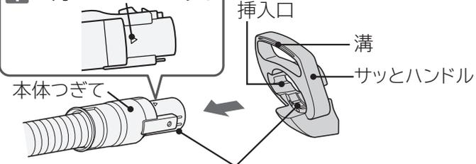
2 溝のある方向から、挿入口下側にそわせて差し込む
