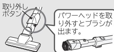
クルッとブラシを延長管(パワーヘッドとの間)に取り付けると、ホーススタンドと本体の溝の高さが合わなくなるため、収納ができなくなります。収納するときは延長管から外すか、手もとと操作部に取り付けてください。
