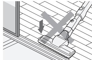
●敷居の段差などにパワーへッドを強く押しつけてご使用になると、車輪などが摩耗し、床面に傷を付けることがあります。
