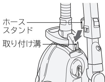
本体を立て、パワーヘッドを床面に置き、延長管を伸ばした状態から徐々に短くして、取り付け溝にホーススタンドを差し込むと楽にセットできます。
