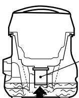
フロートが動作すると吸い込力がなくなり、ごみ捨てサインが動作します。
