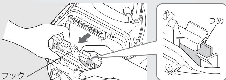
取り付け状態（ボール紙をフックの取り付け線に合わせる）
