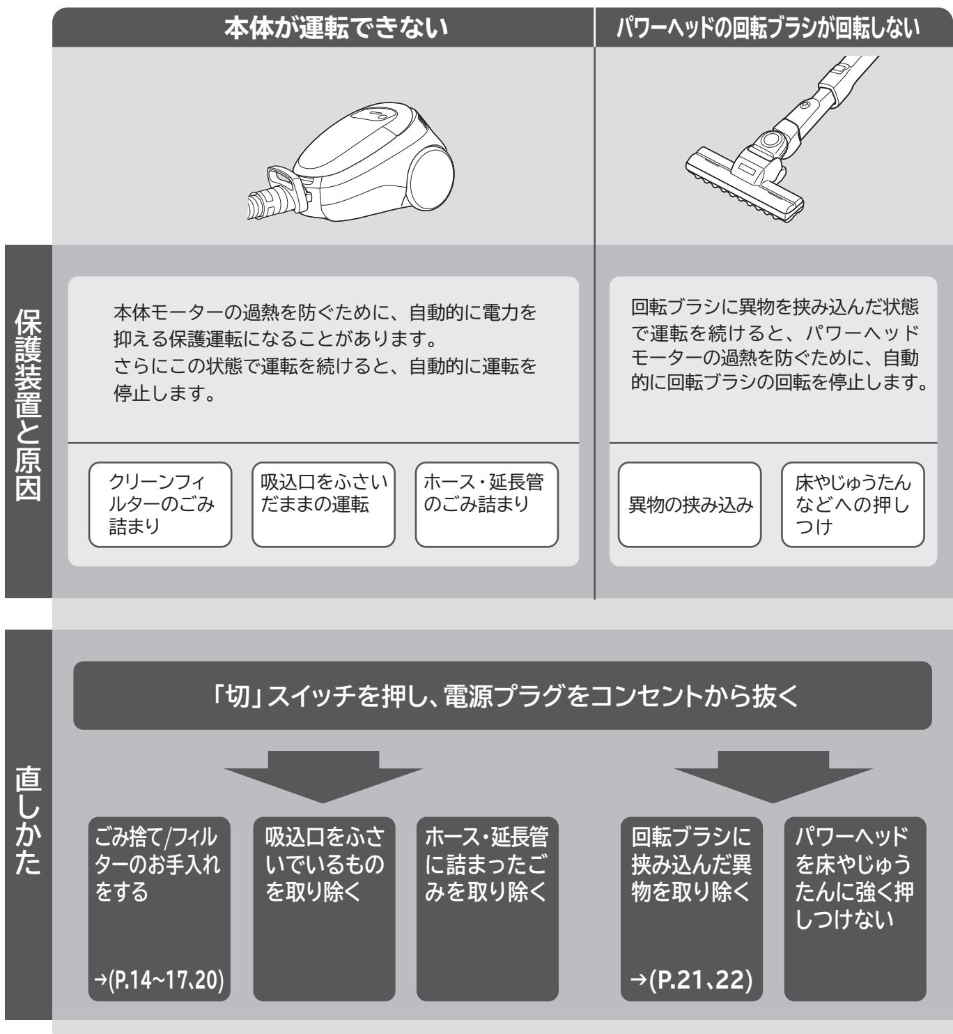
約5分後～60分後に保護装置が解除され、再びご使用いただけます。
