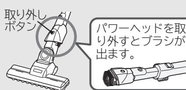
クルッとブラシを延長管側(パワーHEADとの間に取り付けると、ホーススタンドと本体の溝の高さが合わなくなるため、収納ができなくなります。収納するときは延長管から外すか、手もと操作部に取り付けてください。
