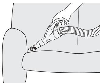
お掃除する場所に合わせてブラシの使い分けができます。切替えブラシの側面を持って矢印の方向に回転させ、先端に固定してください。
