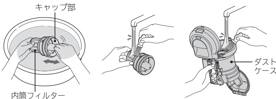
キヤップ部を矢印の方向に10回程度動かして水洗いしてください。
