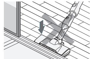
●敷居の段差などにパワーへッドを強く押しつけてご使用になると、車輪などが摩耗したり、床面に傷を付けることがあります。
