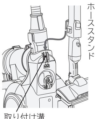
本体を立て、パワー・ヘッドを床面に置き、延長管を伸ばした状態から徐々に短くして、取り付け溝にホーススタンドを差し込むと楽にセットできます。
