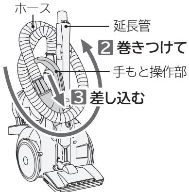
パッとブラシを取り外すと、ホースを延長管に巻きつけて、延長管の差し込み穴にスタンダードフックを差し込みます。
