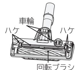
毛足の長いじゅうたんなど床面の種類によっては、操作が重くなることがあります。このようなときは、「弱」運転に切り替えるか、延長管の長さを調節し、グリップハンドルの高さを下げる操作してください。
