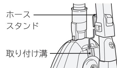
本体とエアーヘッドを右図のように置き、延長管を伸ばした状態から徐々に短くして、取り付け溝にホーススタンドを差し込むと楽に収納できます。
