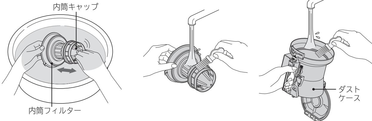
内筒キャップを矢印の方向に10回程度動かして水洗いしてください。
