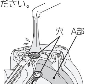
キャップ部を矢印の方向に10回程度動かして水洗いしてください。
