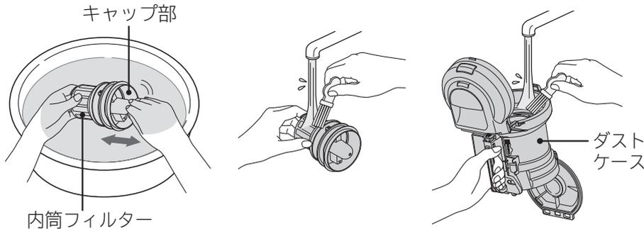
キャップ部を矢印の方向に10回程度動かして水洗いしてください。
