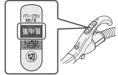
床面の種類やパワーヘッドの操作のしかたによって、自動運転がうまく作動しないときにもお使いください。
