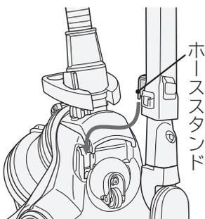
本体を立て、パワーヘッドを床面に置き、延長管を伸ばした状態から徐々に短くして、取り付け溝にホーススタンドを差し込むと楽に収納できます。
