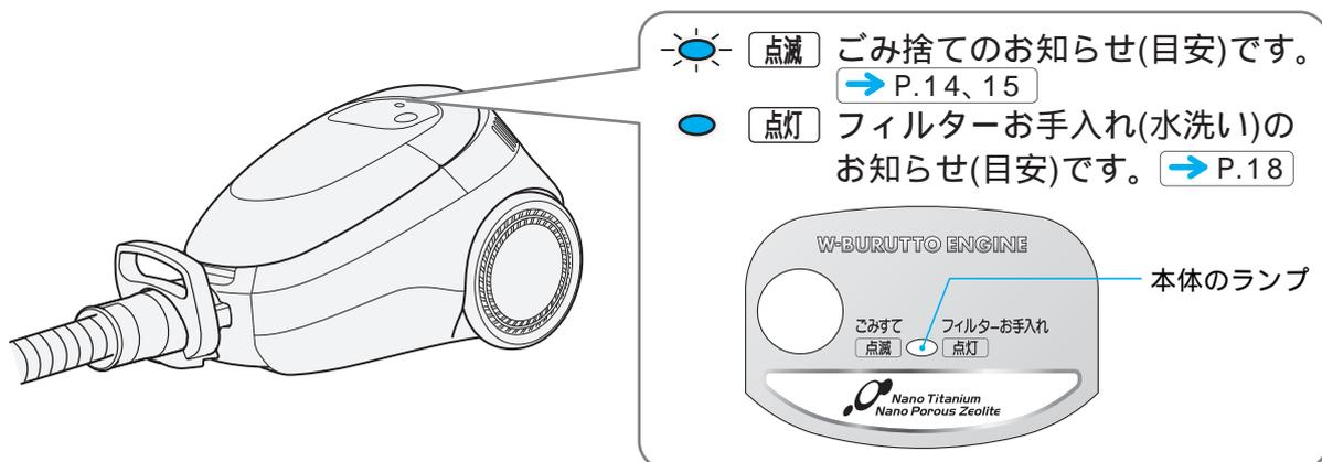
本体のランプが点灯すると同時に、パワーヘッドモーターの過熱を防ぐために、自動的に回転ブラシの回転が止まります。 → P.22 本体のランプが点灯しているときは、「パワーブラシ切/入」スイッチを押しても、回転ブラシは回転しません。
