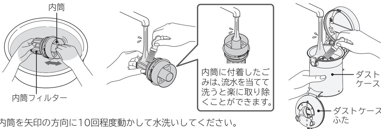
内筒を矢印の方向に10回程度動かして水洗いしてください。
