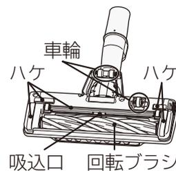
毛足の長いじゅうたんなど床面の種類によっては、操作が重くなる場合があります。このようなときは、「弱」運転に切り替えるか、延長管の長さを調節し、グリップハンドルの高さを下げて操作してください。
