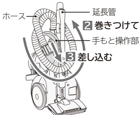
パツとブラシを取り外すと、ホースを延長管に巻きつけて、延長管の差し込み穴にスタンドフックを差し込めます。
