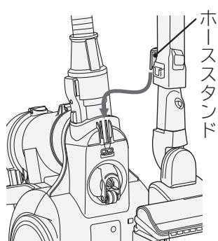
本体を立て、パワーヘッドを床面に置き、延長管を伸ばした状態から徐々に短くして、取り付け溝にホーススタンドを差し込むと楽に収納できます。
