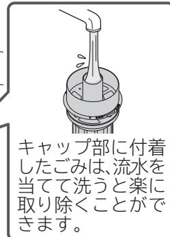
キャップ部を矢印の方向に10回程度動かして水洗いしてください。
