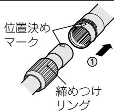
②使いやすい長さに調節し、締めつけリングを回して固定します。
