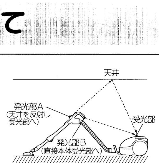
一度押して運転が切り換わらないときは、手もと操作部の角度を変えて何度か押し直してください。
