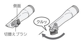
左右いずれかのフックに差し込んで収納します。 クルッと切替えブラシ吸口の穴を延長管のフックに しっかり差し込んでください。
