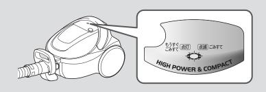
「本体のランプ」が点滅したまま運転を続けると、本体モーターの過熱を 防ぐために、自動的に電力を抑える保護運転になることがあります。 さらにこの状態で運転を続けると、自動的に運転を停止します。
