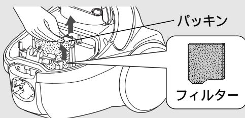
2 フィルターを水で軽く押し洗いし、たたいて水気を切り、十分に自然乾燥させる
